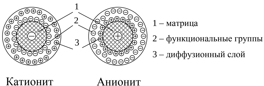
Рисунок 8 – Схема структуры молекулы ионита
