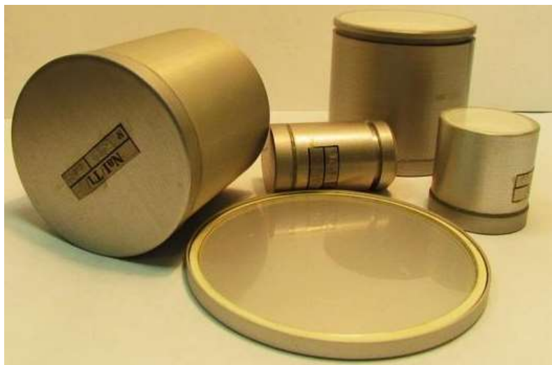
Рисунок 3.10 - Внешний вид сцинтиллятора (йодистый натрий, активированный таллием)
