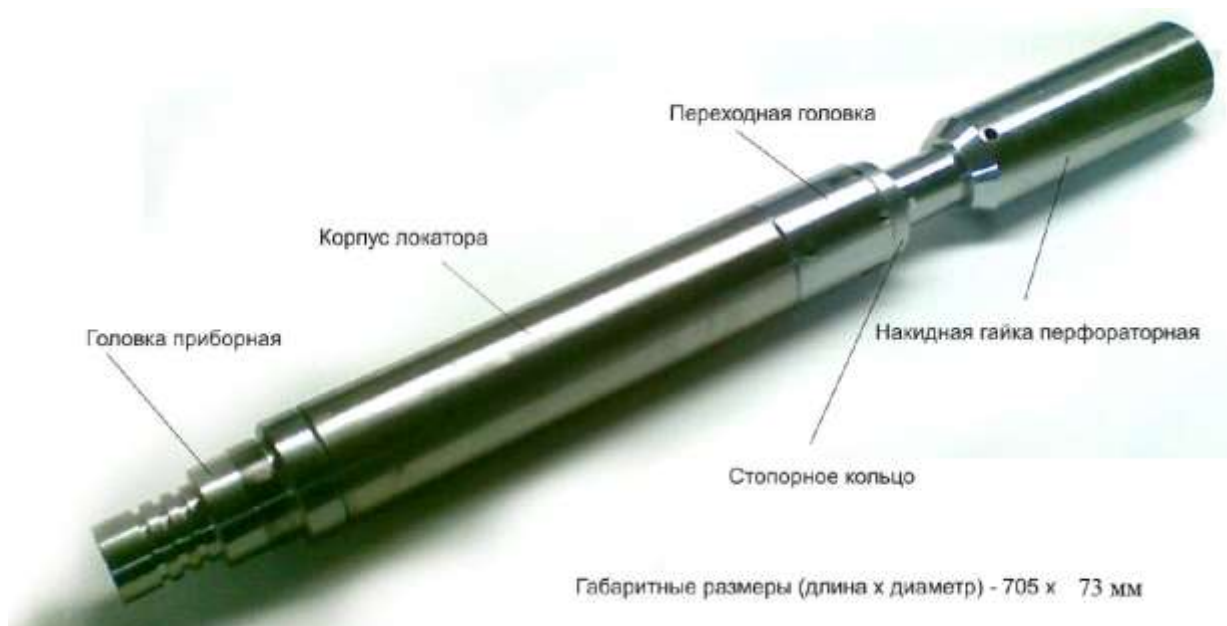
Рисунок 10.5 - Общий вид локатора муфт
