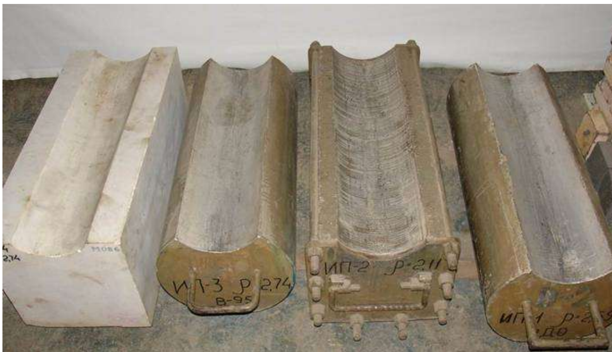
Рисунок 11.2 - Имитаторы плотности для аппаратуры плотностного ГГК
