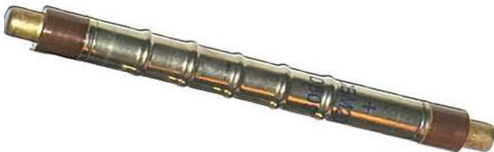
Рисунок 3.1 - Внешний вид газонаполненного детектора ионизирующего излучения
