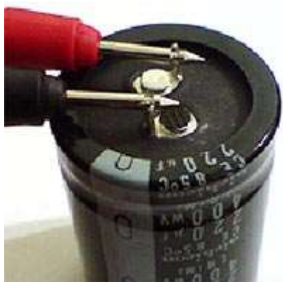
Рисунок 1.9 – Как необходимо прозванивать конденсатор
