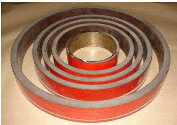
Рисунок 11.3 - Фото комплекта 5-ти эталонных колец для градуировки и калибровки каверномеров-профилемеров
