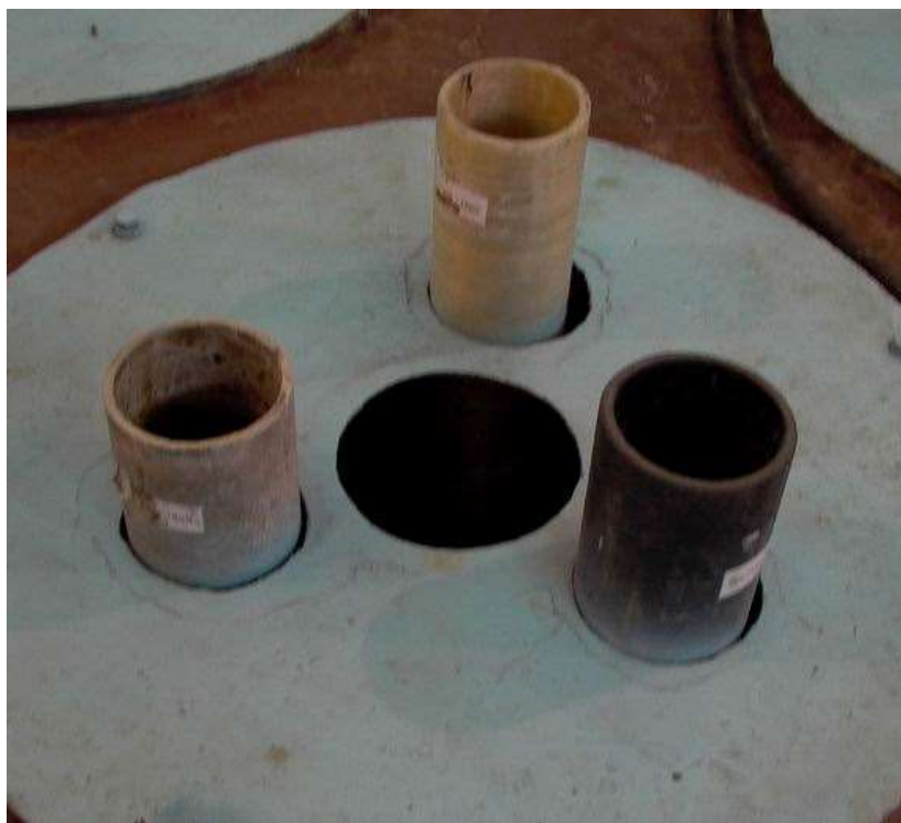
Рисунок 11.6– Имитаторы для градуировки аппаратуры АК
