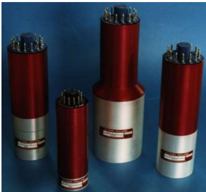
Рисунок 3.7 - Внешний вид сцинтилляционного счетчика
