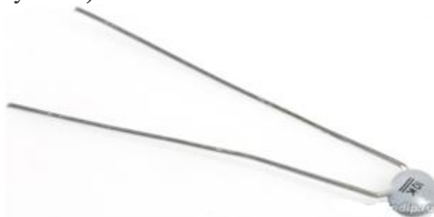
Рисунок 1 – Термистор B57164-K 102-J, 10 кОм, 5%, NTC
