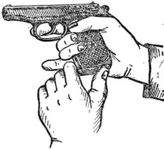
Рис. 3. Извлечение магазина из основания рукоятки
