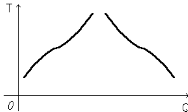
Рис. 4. Кривые плавкости аморфного тела.
