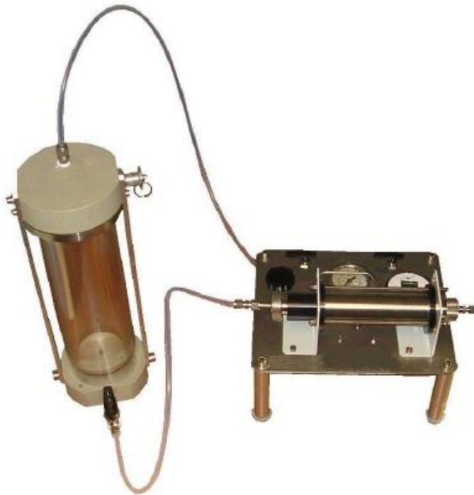
Рисунок 5.2 - Принципиальная схема установки для определения цилиндрических образцов горной породы по жидкости на жидкостном пермеамetre LIQPERM
