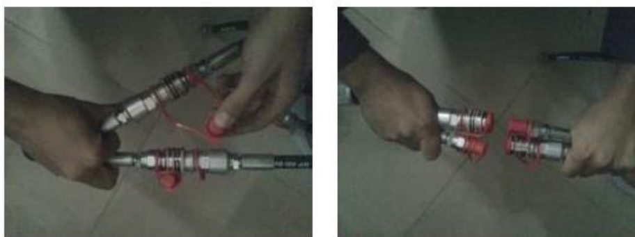
Рис. 4 Защита гидроразъемов от пыли и грязи
