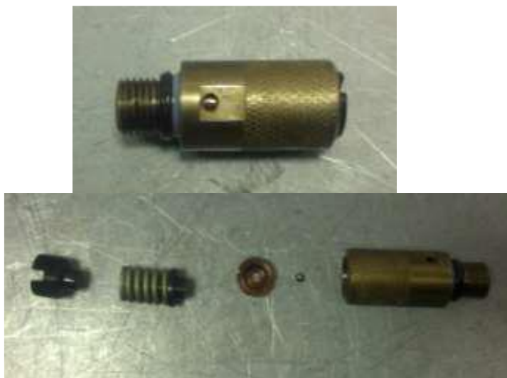
Рис. 3. Предохранительный клапан в сборе (слева), разобранный (справа)
