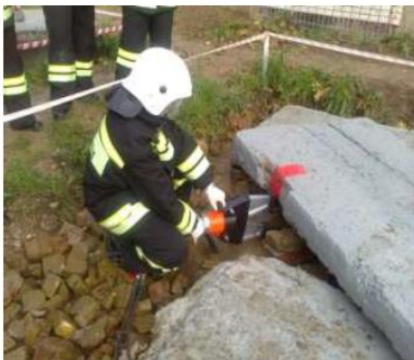
Рис. 8 Применение гидроинструмента для подъема и фиксации на нужной высоте отдельных, элементов завала
