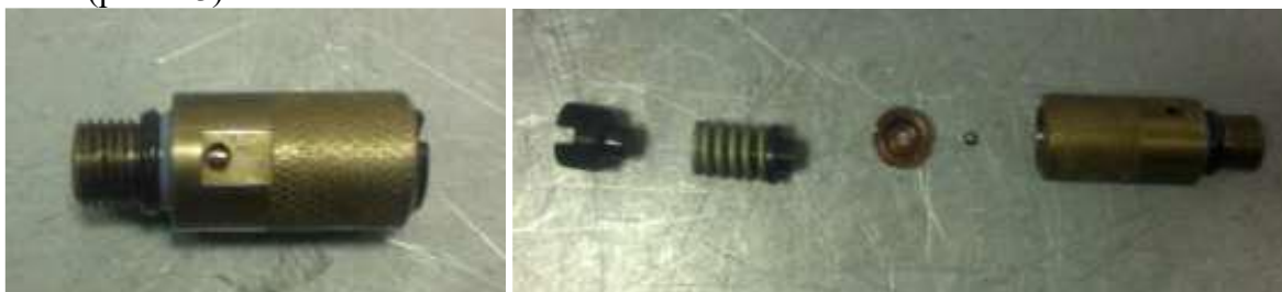
Рис. 1.3. Предохранительный клапан в сборе (слева), разобран (справа)
