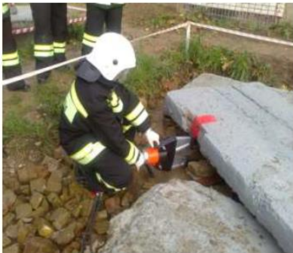
Рис. 1.8 Применение гидроинструмента для подъема и фиксации на нужной высоте отдельных, элементов завала
