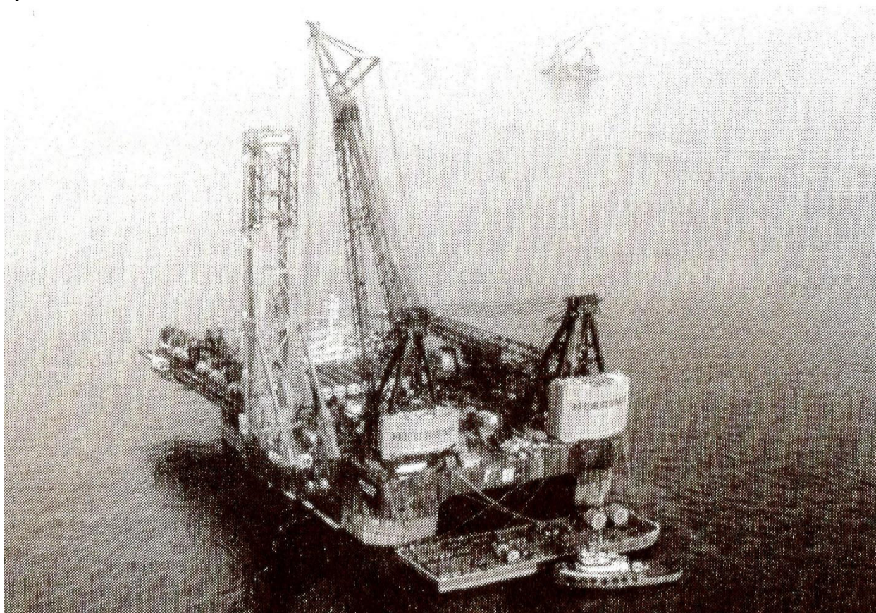
Рисунок 4 - Вышка для J-образной прокладки на крановом судне "Baider"
