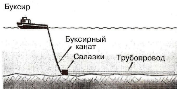
Рисунок 8 - Технологии буксировки и монтажа трубопровода
