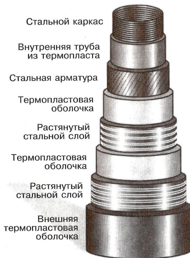
Рисунок 1 - Конструкция гибкого трубопровода
