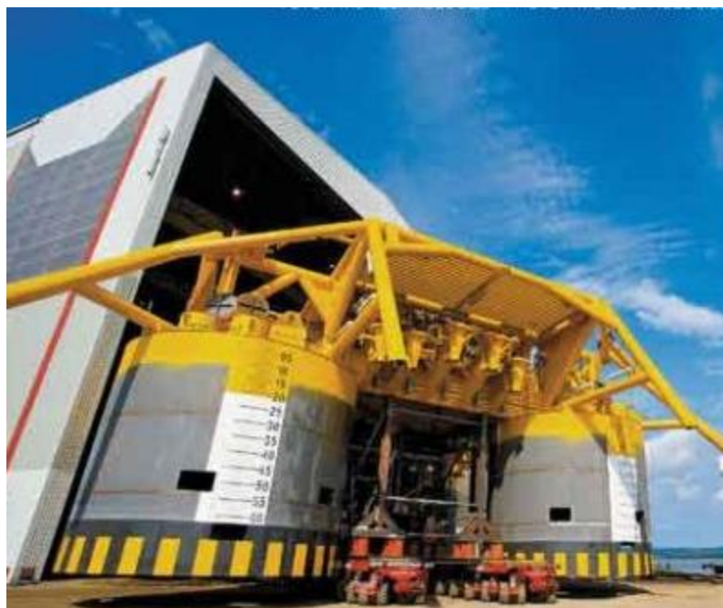
Рис. 13.1. Подводные модули с месторождения Ormen Lange, «Статойл» Templates from Statoil's Ormen Lange field
