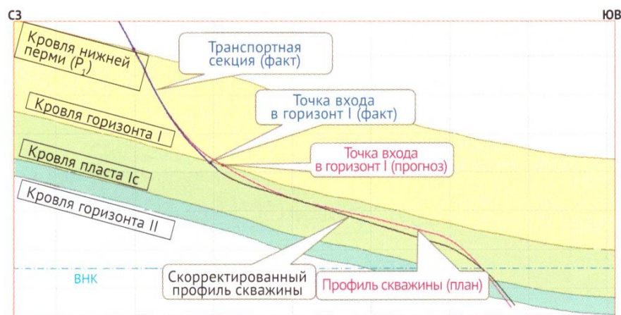
Рис. 5.8. Уточнение структурной модели кровли целевого пласта и корректировка плановой траектории по результатам вскрытия кровли продуктивного горизонта
