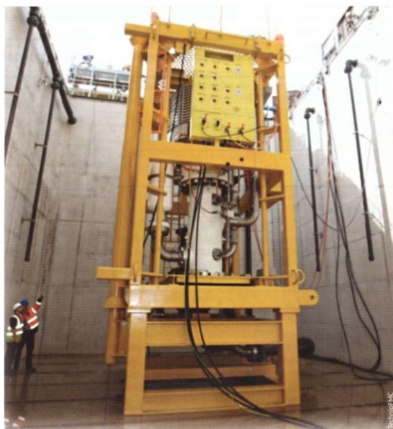
Рис. 14.4. Подводный насосный модуль мощностью 3,2 МВт в погружном испытательном шурфе
