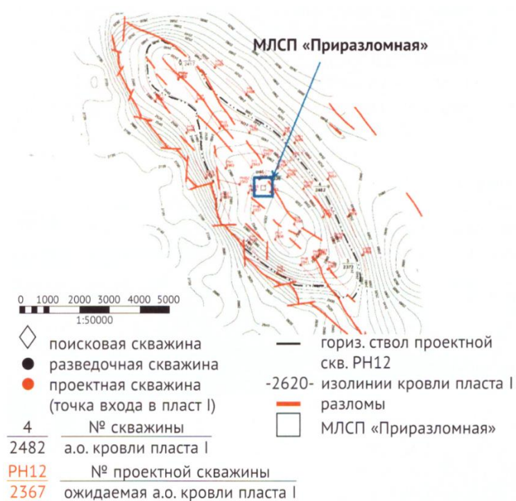
Рис. 5.3. Схема скважинного «паука» в плане
