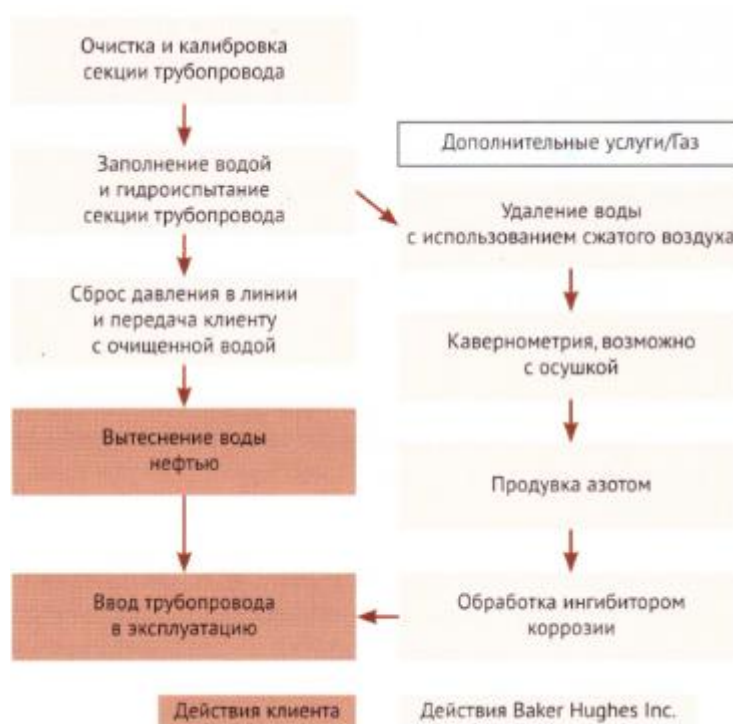
Рис. 9.1. Технологическая схема процесса предпусковых работ для типовых нефтепроводов
