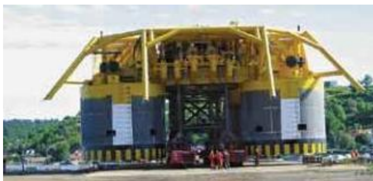
Рис. 13.3. Подводные модули с месторождения Ormen Lange, «Статойл» Templates from Statoil's Ormen Lange field
