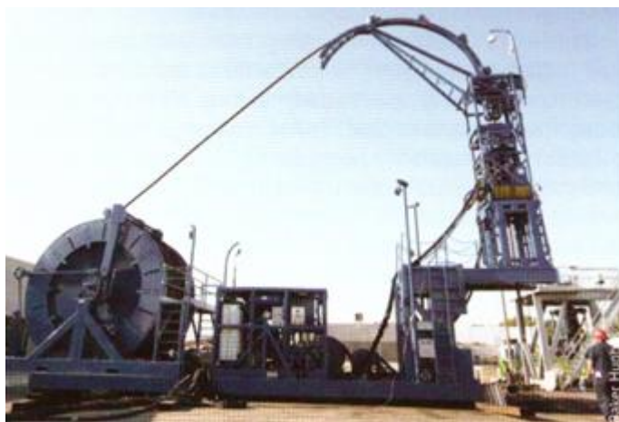
Рис. 9.4. Колтюбинговая система в развёрнутом состоянии
