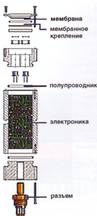
Рис. 17.2. Датчик углеводородов мембранного типа
