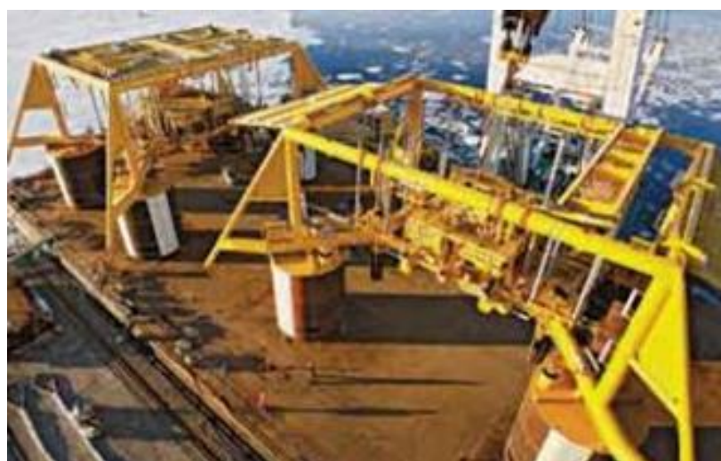
Рис. 13.2. Донные плиты с месторождения Vega «Статойл» Templates from Statoil's Ormen Lange field
