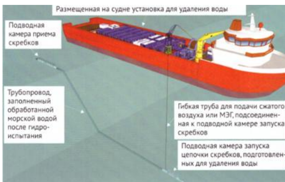
Рис. 9.2. Схема удаления воды с использованием судовой колтюбинговой системы
