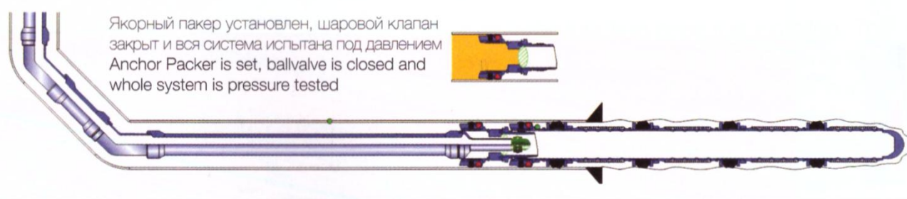
Рис. 7.6. Установка и опрессовка пакера-якоря
