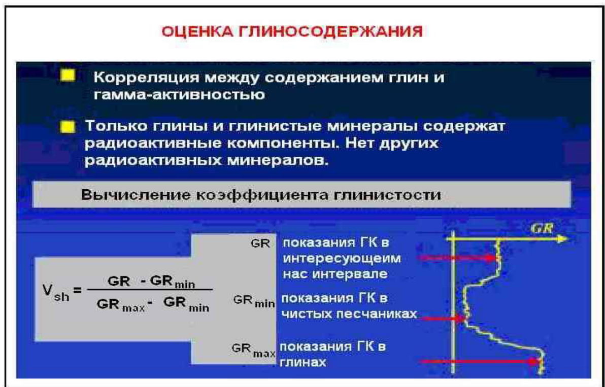
Рисунок 4.2 – Пример оценки глиносодержания
