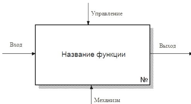
Рис. 1. Элемент нотации IDEF0
