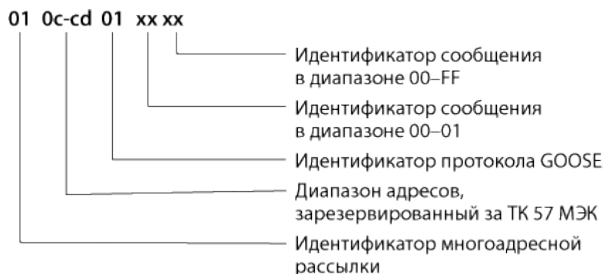
Рисунок 1.1 – Диапазон адресов многоадресной рассылки для GOOSE-сообщений
