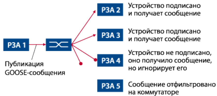
Рисунок 1.2 – Схема передачи GOOSE-сообщений
