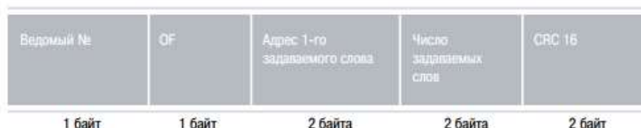
Рисунок 5 –Формат запросного и ответного сообщений при записи нескольких слов
