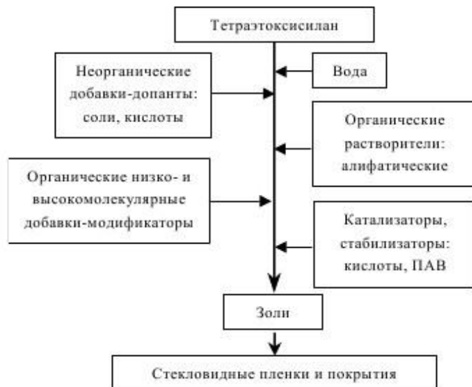
Рисунок 7.2 – Блок-схема: основные компоненты золь-гель-систем для получения силикатных и гибридных органо-неорганических пленок и покрытий.
