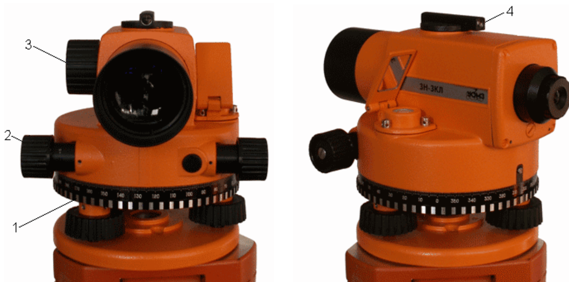
Рис. 6. Точный нивелир 3Н-3КЛ с компенсатором и лимбом: 1 – лимб; 2 – наводящий винт; 3 – кремальера; 4 – визир
