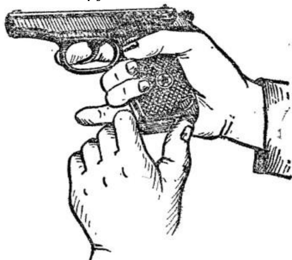
Рис. 3. Извлечение магазина из основания рукоятки
