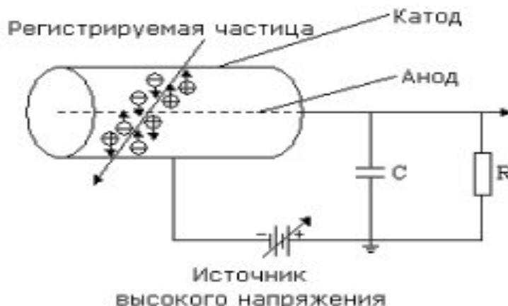
Рисунок 2. 4 – Принципиальная схема конструкции ГС
