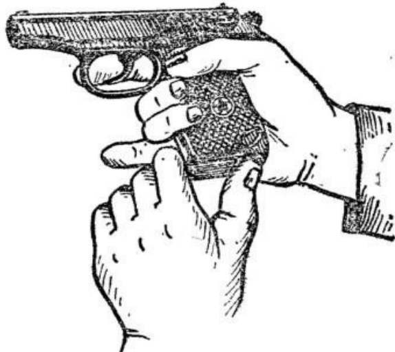
Рис. 3. Извлечение магазина из основания рукоятки
