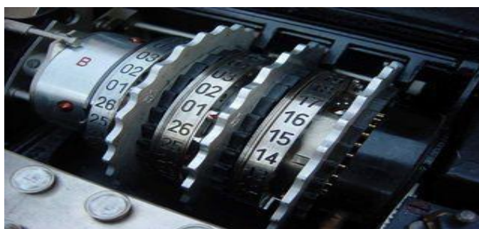
Рис. 3.7. Роторы Энигмы в собранном состоянии. Три подвижных ротора помещены между двумя неподвижными деталями: входное кольцо и рефлексор (помечен "В" слева)
