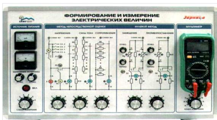
Рисунок 1 – Установка для формирования и измерения электрических величин
