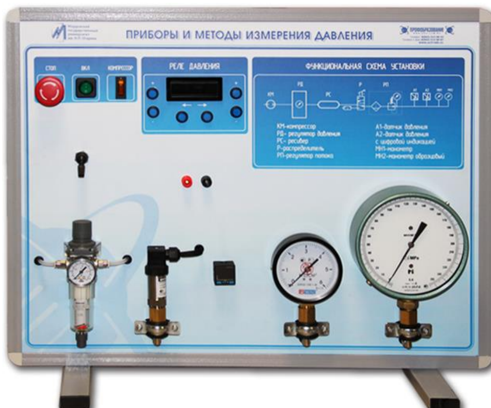
Рисунок 2 – Внешний вид комплекта учебно-лабораторного оборудования «Приборы и методы измерения давления» (ПМИД-СР)
