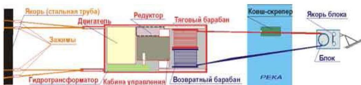
Рисунок 4.3 – Схема монтажа КСУ
