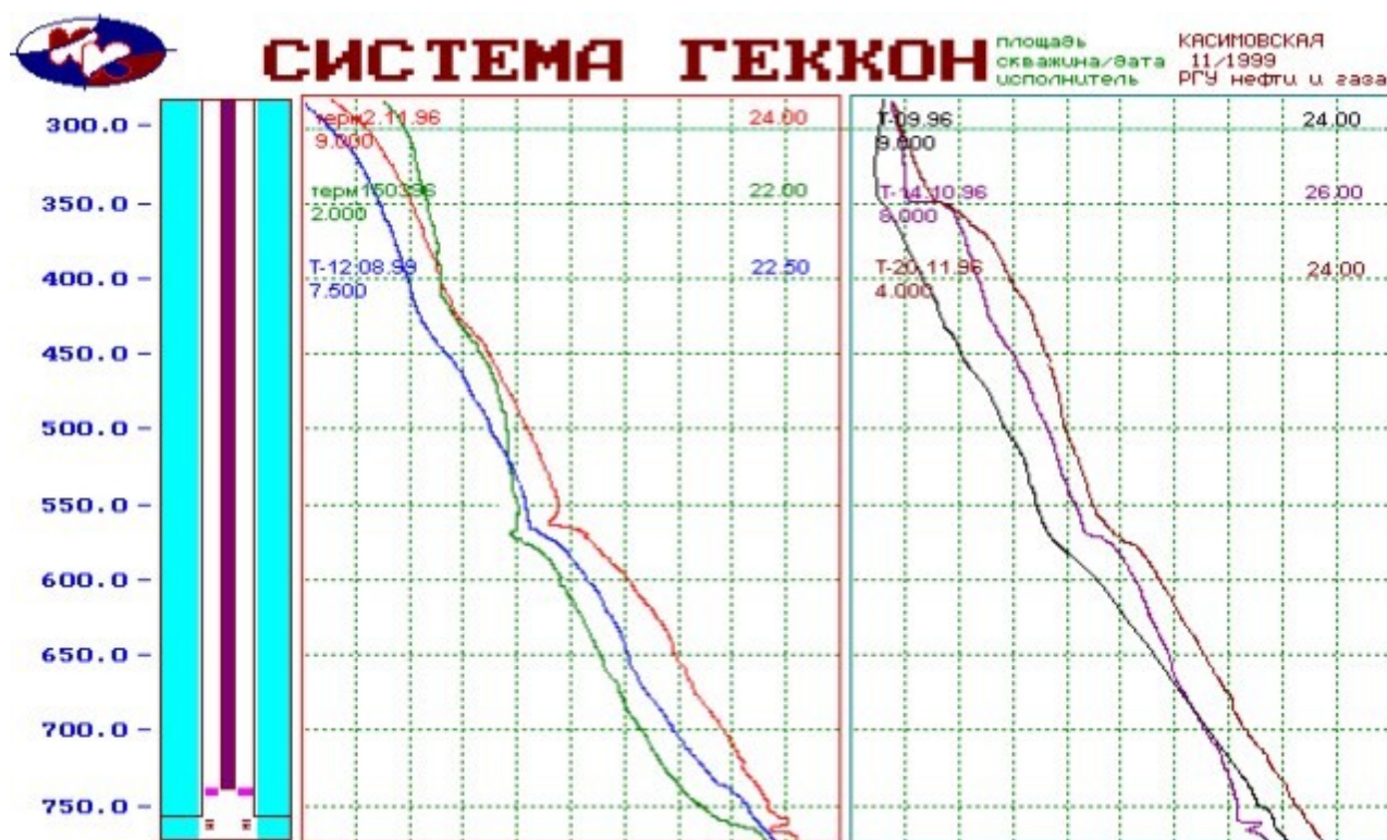
Рисунок 5.2 - Пример серии замеров термометром в период отбора газа
