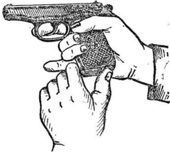
Рис. 3. Извлечение магазина из основания рукоятки
