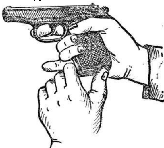
Рис. 3. Извлечение магазина из основания рукоятки
