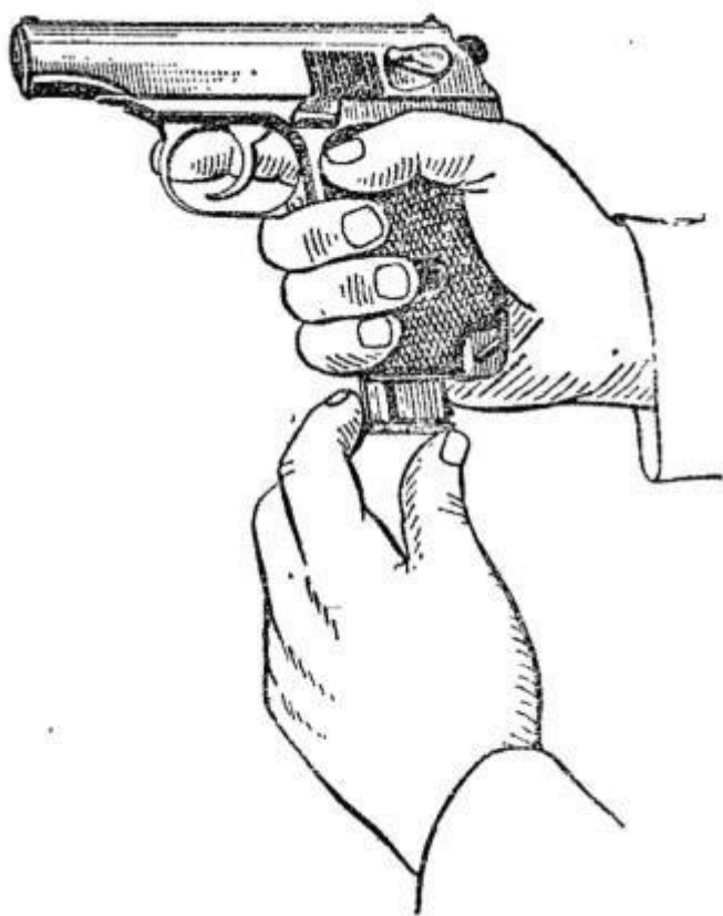
Рис. 8. Вставление магазина в основание рукоятки
