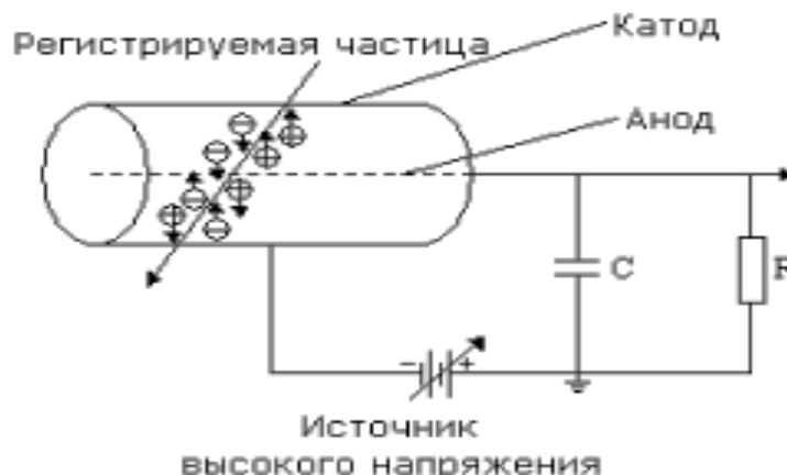
Рисунок 2. 4 – Принципиальная схема конструкции ГС
