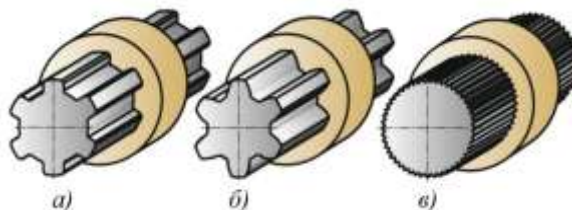
Рисунок 8 – Типы шлицевых соединений: а) – с прямобочными шлицами; б) с эвольвентными шлицами; в) с треугольными шлицами
