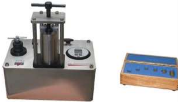
Рис. 3.1. Принципиальная схема установки для измерения пористости
