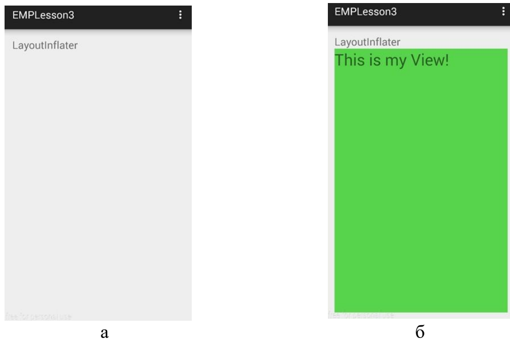
Рисунок 3.1 – Пример первоначального интерфейса (а) и интерфейса с добавлением дочернего View-элемента из содержимого layout-файла (б)
