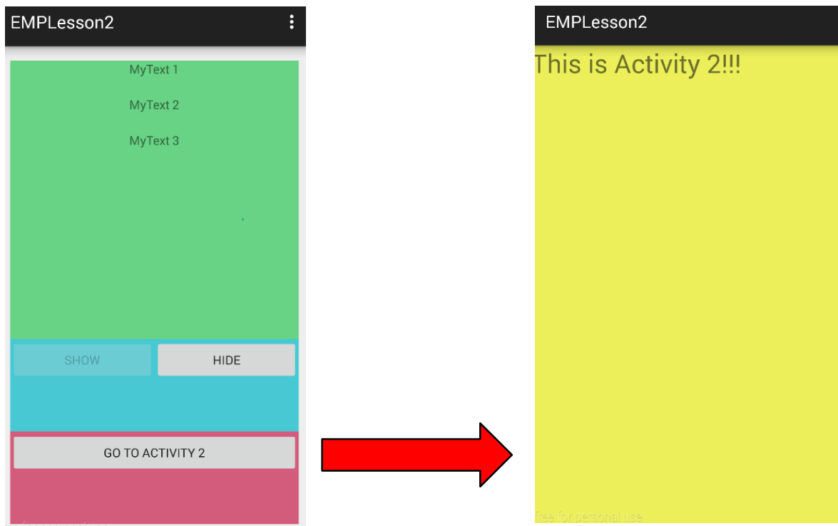
Рисунок 2.4 – Пример вызова нового Activity в ответ на нажатие на одноименную кнопку в исходном Activity
