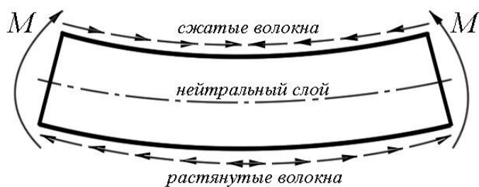
Рисунок 6.1 – Деформации изгиба балки
