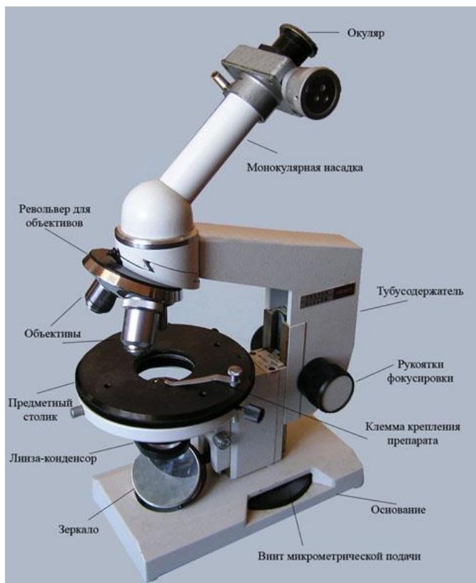
Рис. 3. Основные узлы микроскопа «Биолам»
