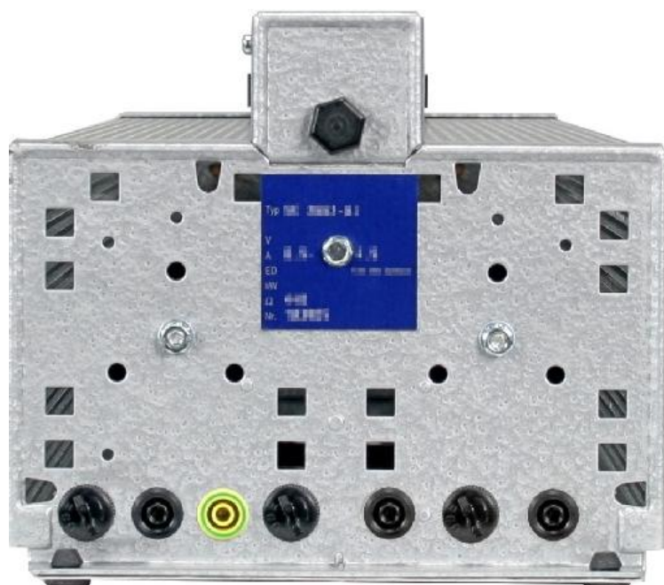
Рисунок 3.5 – Нагрузочное сопротивление для синхронного генератора
