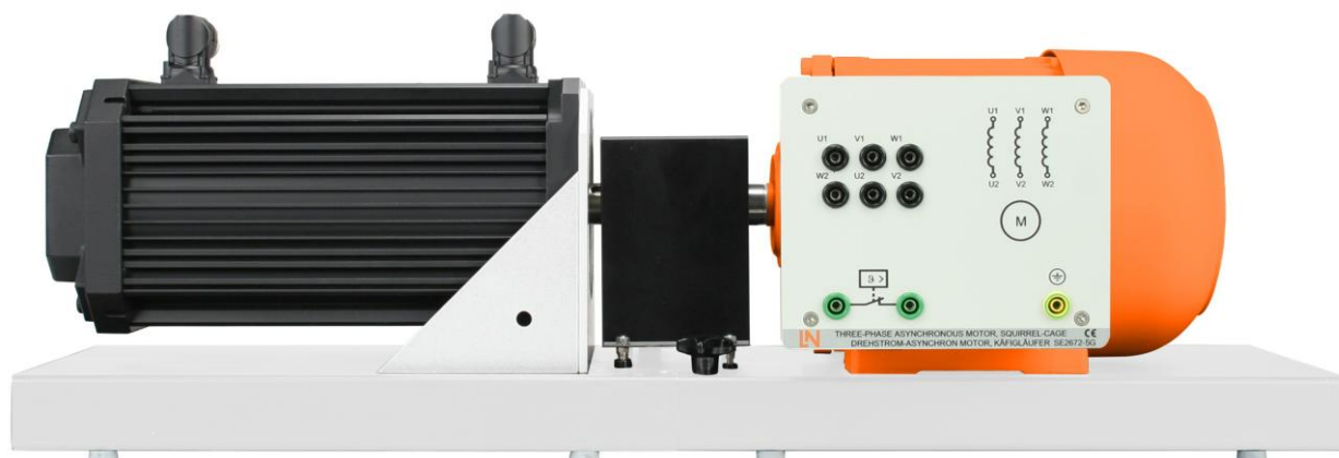
Рисунок 5.5 – Испытательный стенд серво-двигателя 1 кВт
