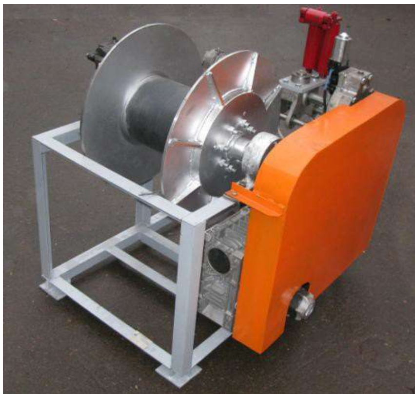
Рисунок 5 – Лебедка с электроприводом и одножильным бронированным кабелем
