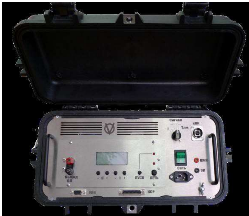
Рисунок 6 – Цифровой каротажный регистратор «Велко-Гео»
