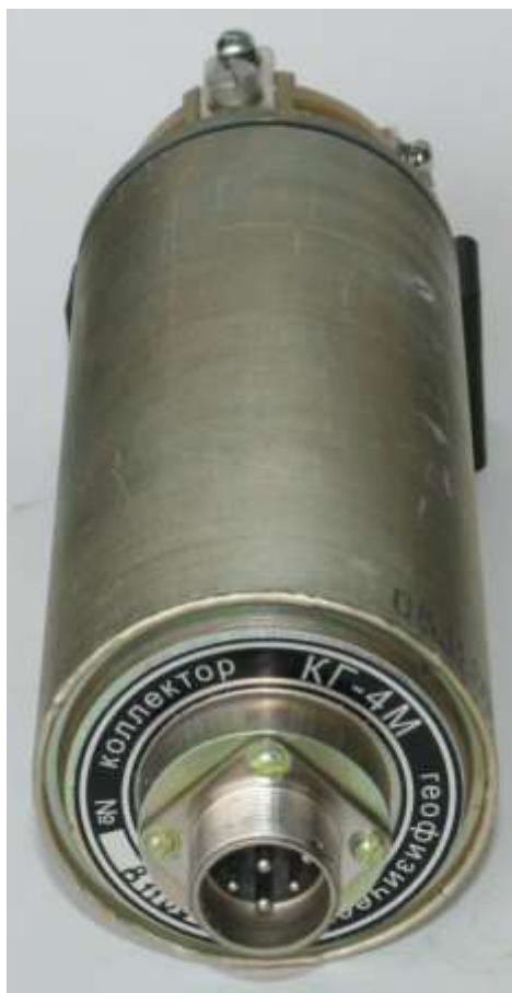
Рисунок 9 – Геофизический коллектор КГ-4М
