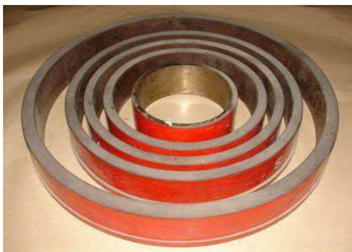
Рисунок 6 - Фото комплекта 5-ти эталонных колец для градуировки и калибровки каверномеров-профилемеров
