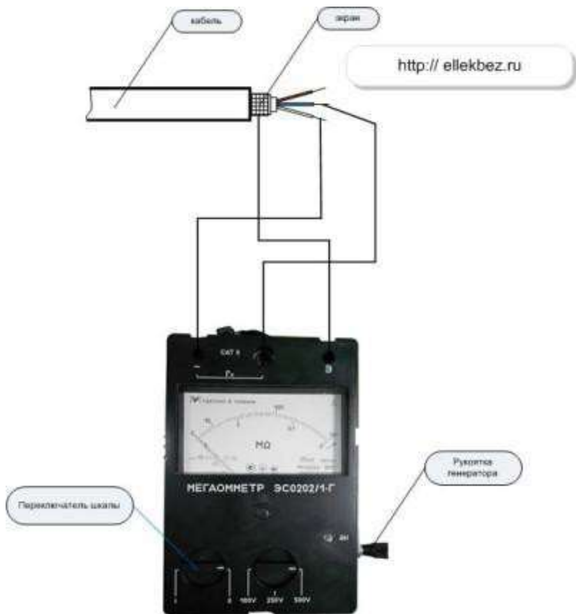
Рисунок 15 – Схема проверки изоляции жил кабеля
