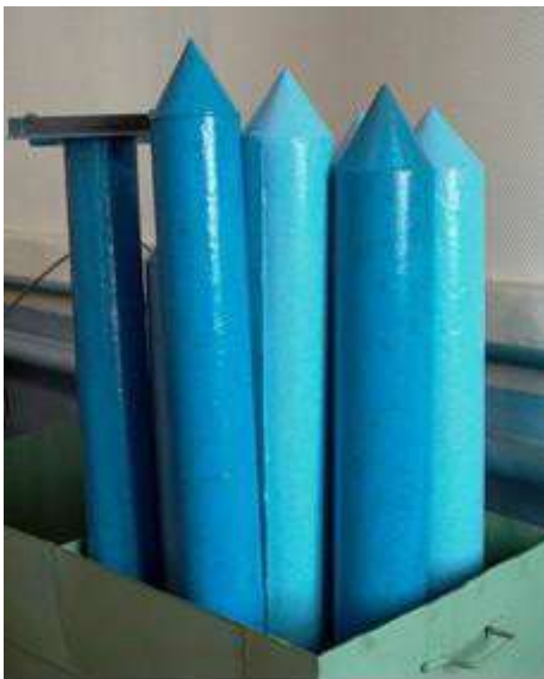
Рисунок 10 – Калибровка каналов аппаратуры нейтронного каротажа
