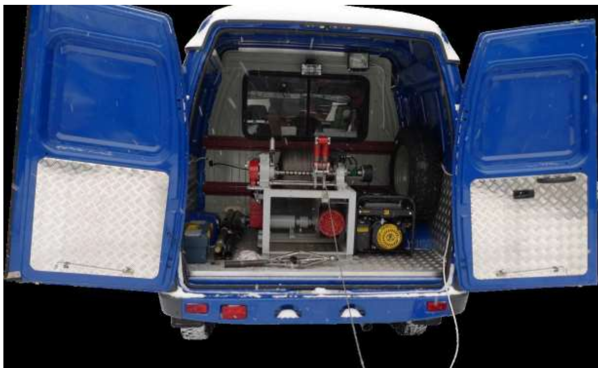
Рисунок 9 – Общий вид каротажной станции СКГ-1 на полноприводном автомобиле «Соболь»
