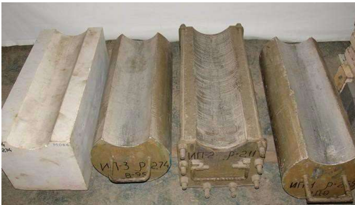
Рисунок 5 - Имитаторы плотности для аппаратуры плотностного ГГК
