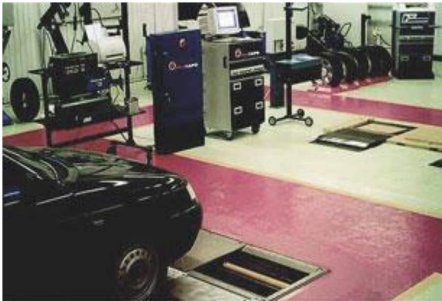
Рисунок 9.2 – Общий вид линии инструментального контроля модели ЛТК-3Л-СП-11 для автотранспортных средств, имеющих нагрузку на ось до 3 т.
