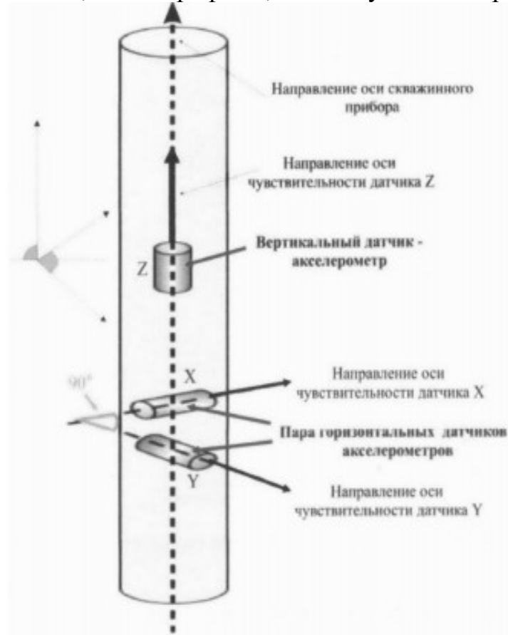
Рисунок 8.3 - Схема прибора трехкомпонентного геоакустического каротажа
