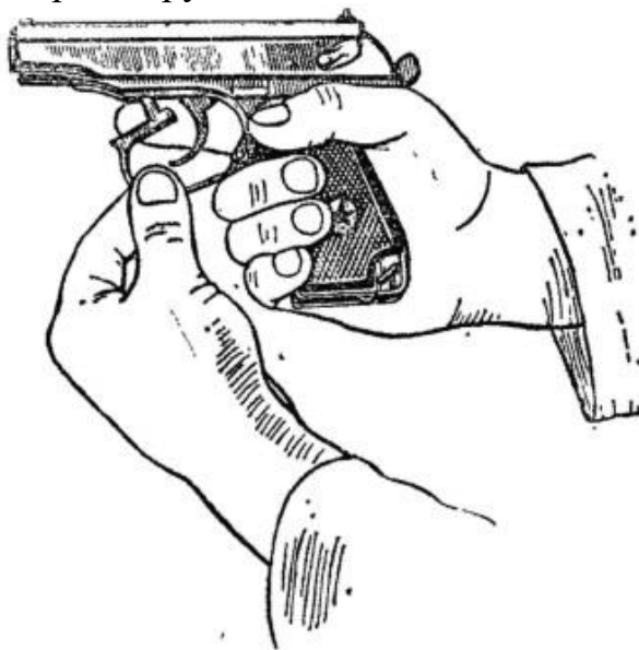
Рис. 4. Оттягивание спусковой скобы
