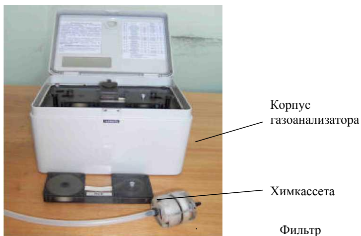
Рисунок 3.2 – Общий вид газоанализатора ГАНК-4
