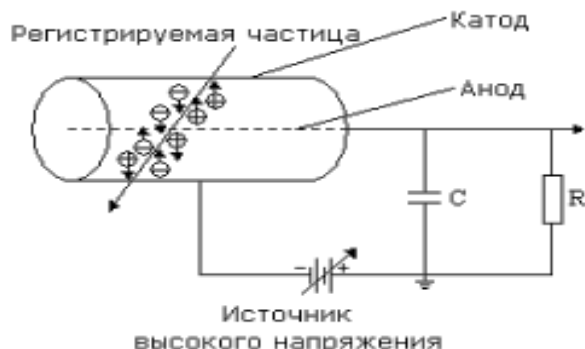
Рисунок 2. 4 – Принципиальная схема конструкции ГС
