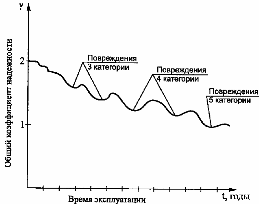
Рисунок 13.1 – Изменение надежности сооружений со временем
