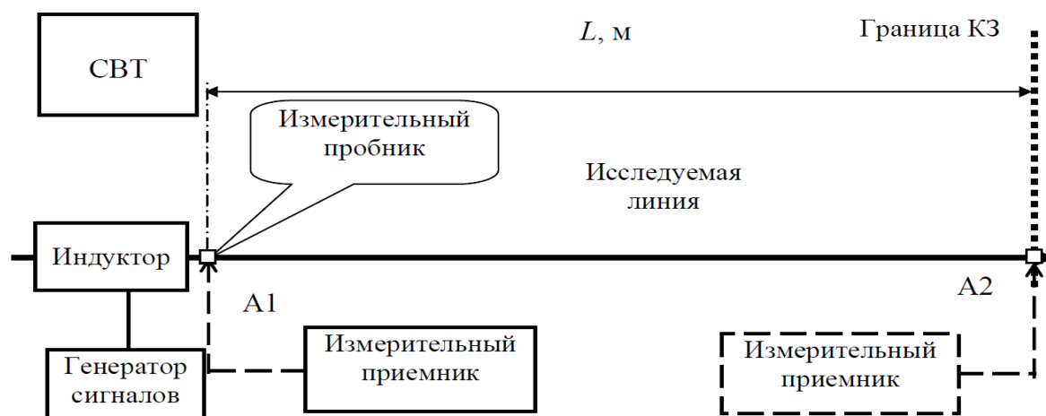
Рисунок 1 - Схема измерения реального затухания в линии
