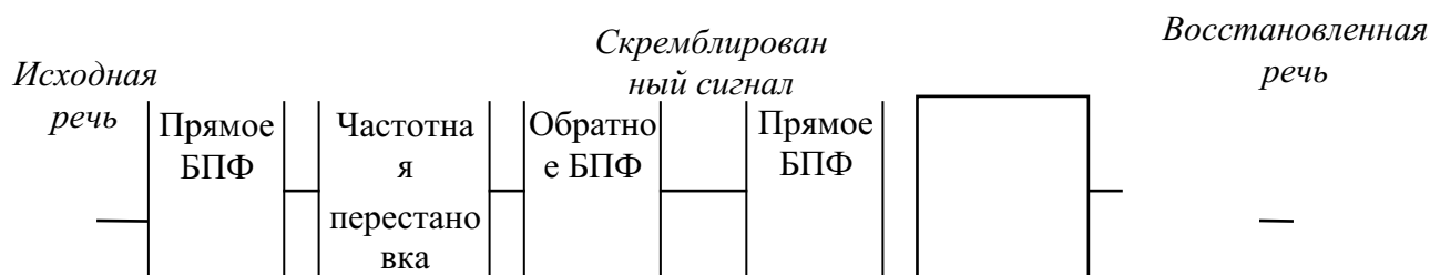
Рис.4. Принцип работы скремблера с использованием преобразования Фурье.
