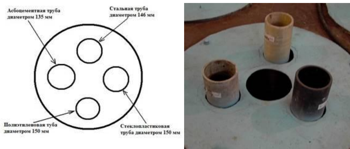
Рисунок 4 – Схема и фото комплекта трубных волноводов для калибровки аппаратуры АК
