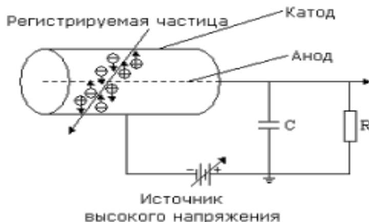
Рисунок 2. 4 – Принципиальная схема конструкции ГС
