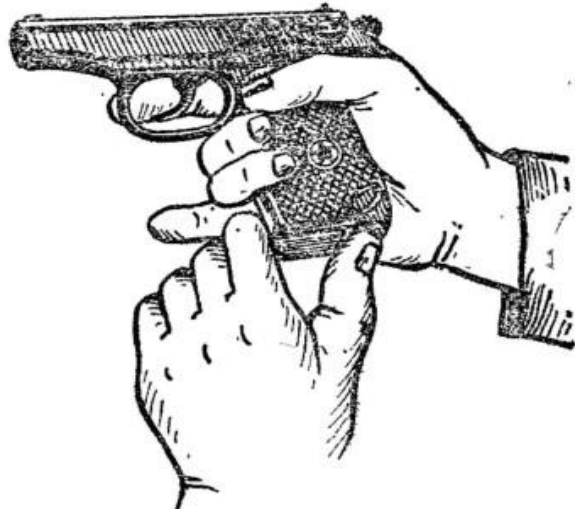
Рис. 3. Извлечение магазина из основания рукоятки
