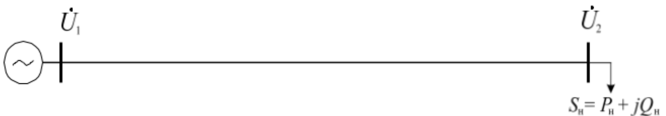
Рисунок 3.9. Расчетная схема электропередач
