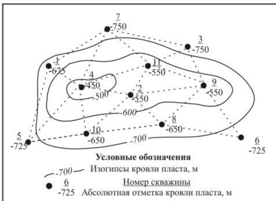
Рисунок 22 Построение структурной карты методом треугольников (по М.А. Жданову)
