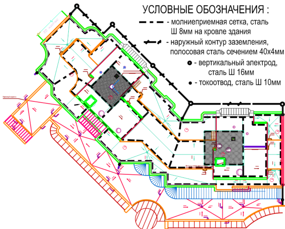
Рисунок 16.8 – Молниезащита и наружный контур заземления секции 1 дома
