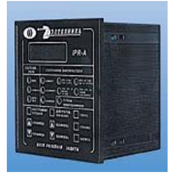
Рисунок 2.8.7 - Блок релейной защиты IPR или SMPR (могут устанавливаться другие виды защит). Функции: защита, запись аварий и событий, самодиагностика, дистанционное управление коммутационным аппаратом.
