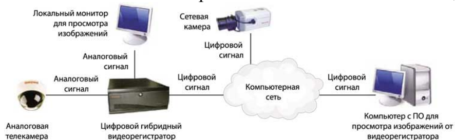
Рис.7. Сетевая система с гибридным видеорегиистратором
