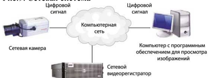
Рис.10. Сетевая система с сетевым видеорегистратором
