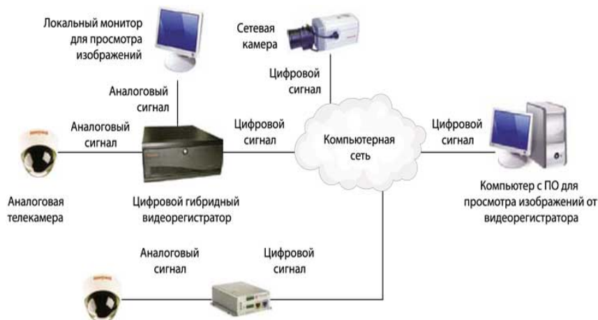
Рис.8. Сетевая система с гибридным видеорегиистратором и сервером
