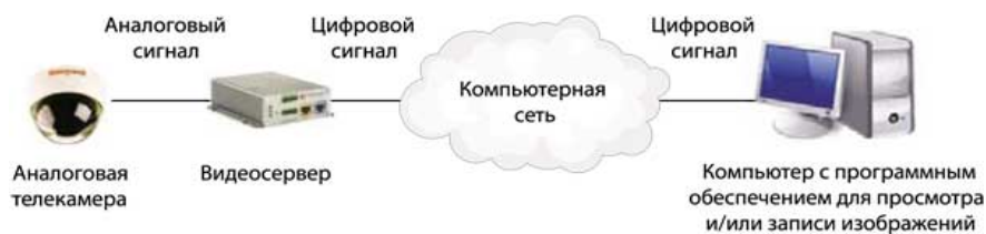
Рис.6. Сетевая комбинированная система с сетевым видеосервером
