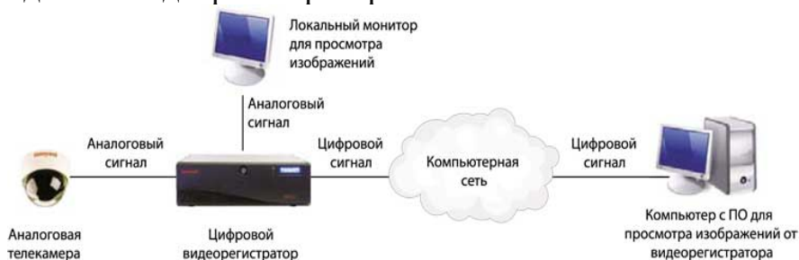
Рис.5. Комбинированная сетевая система на базе гибридного видеорегистратора
