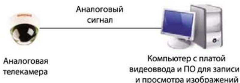
Рис.4. Комбинированная система с цифровой записью на базе
