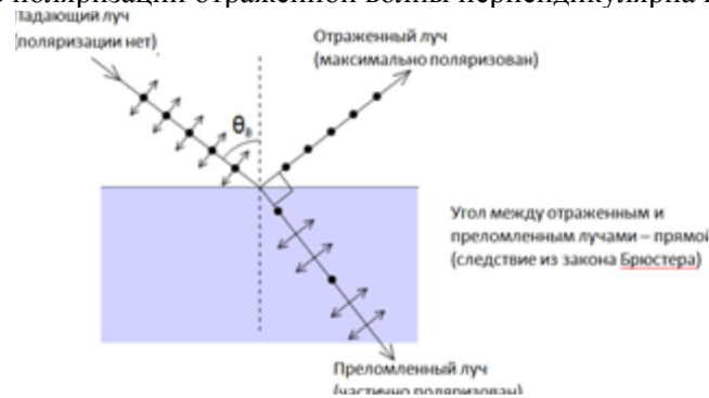
Рис. 9.4. Поляризация при отражении от диэлектрика.
