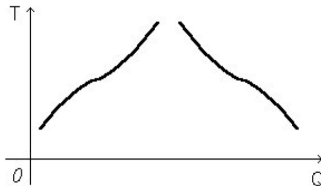
Рис. 4. Кривые плавкости аморфного тела.
