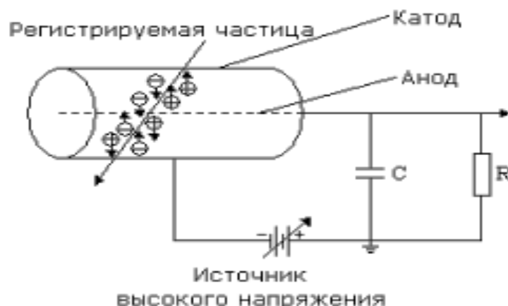
Рисунок 2. 4 – Принципиальная схема конструкции ГС
