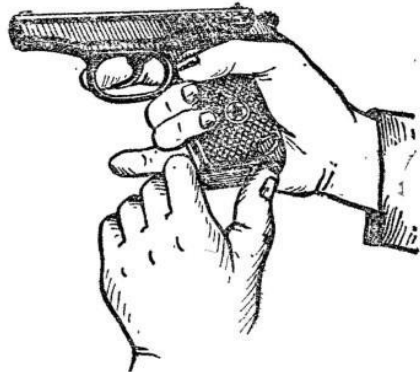
Рис. 3. Извлечение магазина из основания рукоятки
