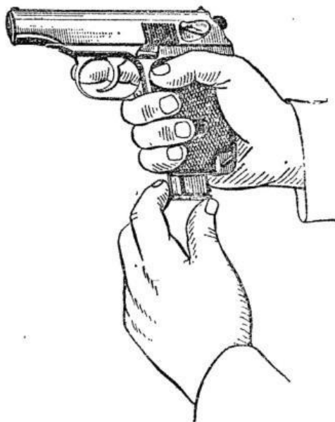
Рис. 8. Вставление магазина в основание рукоятки
