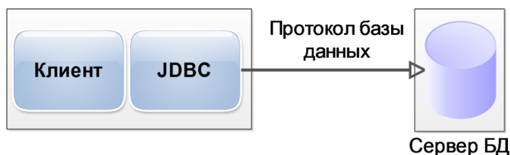
Рисунок 9.1 – Схема приложения типа «клиент-сервер».
