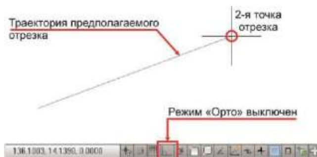
Рисунок 0.2– Построение отрезка без режима «Орто»
