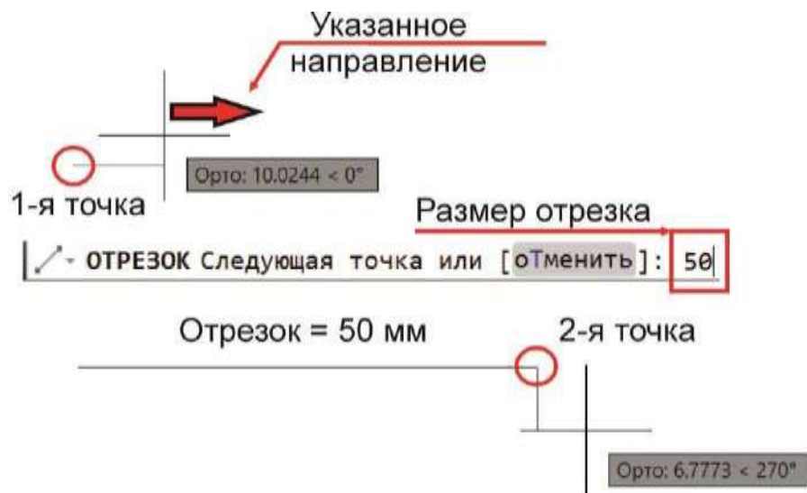
Рисунок 0.4 – Построение отрезка заданной длины
