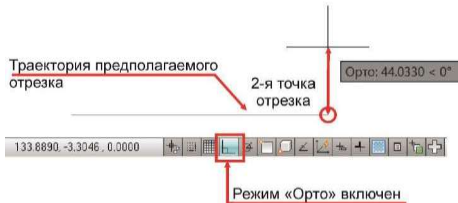
Рисунок 0.3– Построение отрезка в режиме «Орто»
