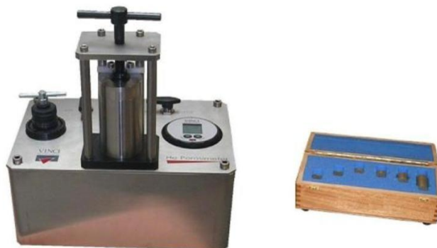
Рис. 3.2. Общий вид прибора для измерения пористости
