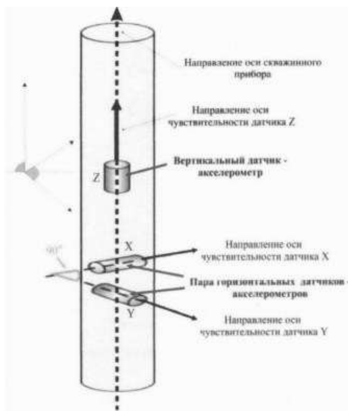
Рисунок 13.3 - Схема прибора трехкомпонентного геоакустического каротажа
